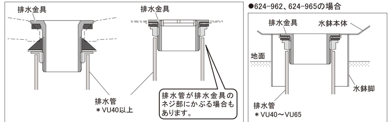
排水管(VU40以上)に排水金具を差込み設置します。
