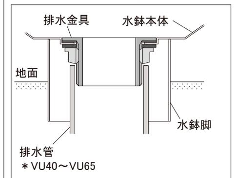
① 排水管(VU40～VU65)に排水金具のネジ部をかぶせるように差込み設置します。
