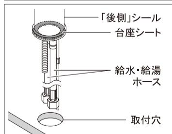
②水栓本体を設置する取付穴の穴径を確認し、穴周囲が汚れていないか確認します。
