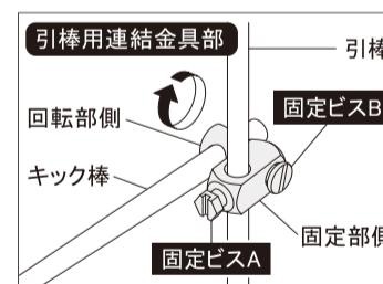
ポップアップ排水金具の排水栓を操作するために、排水金具のキック棒と水栓の引棒を接続します。
