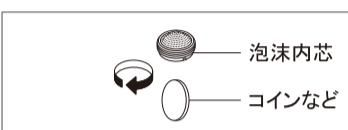
ご使用開始時に比べて著しく水の出が悪くなった場合は、吐水口先端の泡沢内芯を取り外し、ゴミなどの異物を水洗いして取除いてください。
