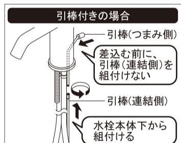
①引棒付きの場合は、先に引棒(つまみ側)を水栓本体に差込みます。次に、引棒(連結側)を水栓本体下から組付けます。
