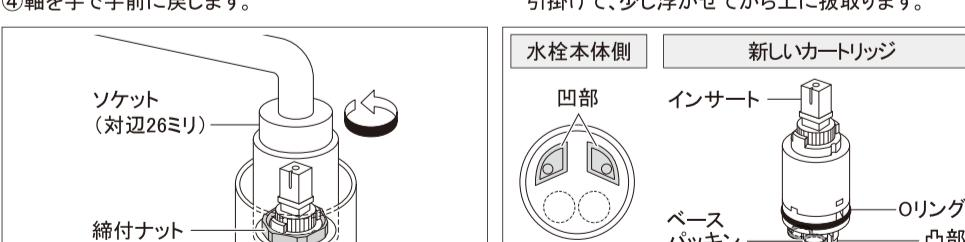
⑥「ソケット(対辺26ミリ)」で、締付ナットを反時計回りにまわしてゆるめ、古いカートリッジと一緒に締付ナットを取り外します。
