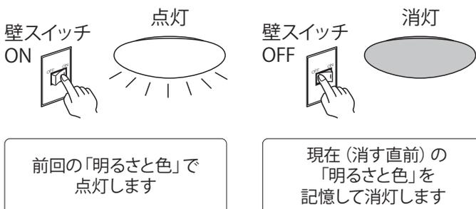
●壁スイッチを「OFF」にする前に、リモコンで消灯した場合再び壁スイッチで「ON」にしても、消灯状態になります。
