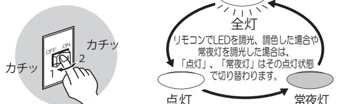
●壁スイッチ1個で2台以上の照明器具を使用しないでください。点灯状態が、同時に切り替わらない場合があります。
