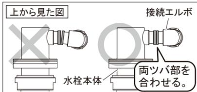
⑥クリップの溝に、両ツバ部が収まるようにクリップをはめ込みます。
