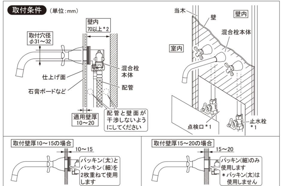
\*1 本品を取付ける際は、配管に止水栓(バルブ)を設置し、点検口を設けてください。
