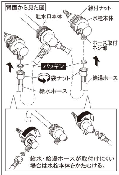
①給水・給湯ホースの袋ナットにパッキンをはめ込み、水栓本体のホース取付ネジ部に「レンチ」などでしっかりと締付けます。
