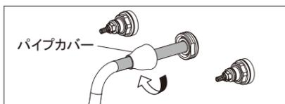
①パイプカバーをパイプ締付ナットに取付けます。
