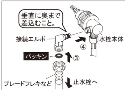
③止水栓と接続したブレードフレキなど(現場調達)を接続エルボに取付けます。
