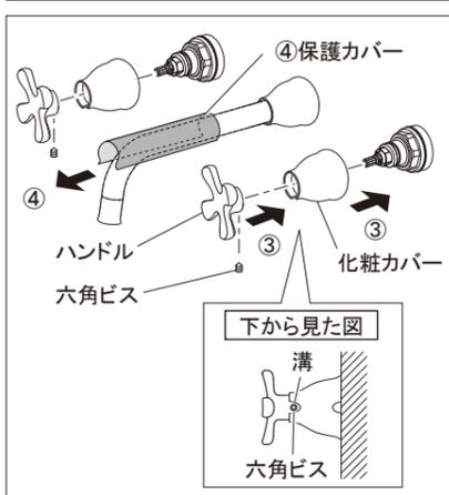
②ハンドルを一度抜き取り、化粧カバーを締付ナットに壁にあたるまで差込みます。
