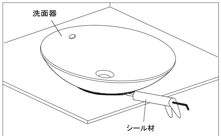
③洗面器裏面(カウンターに接する面)にシール材を塗布し、カウンターに設置します。
