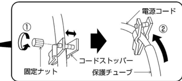
③保護チューブを持って、電源コードの長さを調整する。
