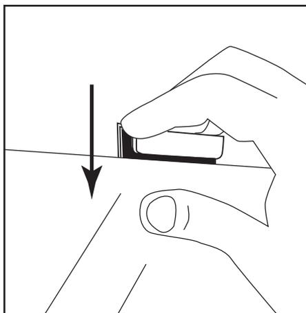
**8** 上の金具にもクッション材を設置し、スライドさせ固定して下さい。
