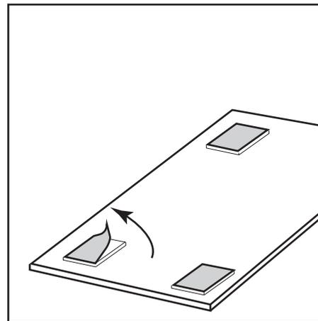
**6** ミラー裏に張り付けてあるミラーマットのシールを剥がして下さい。
