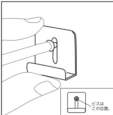
**4** 下の金具をビスでしっかり固定して下さい。\*プラスドライバー使用
