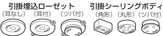
**警告** 下記のような配線器具には取り付けられません。火災、感電、落下によるけがの原因となります。
