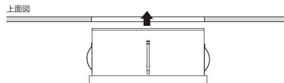
壁にしっかり留めたい場合は、ウレタン系または変成シリコン系接着剤を開口小口に塗ってから製品を挿入してください。
