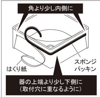
①イラストのように、器の壁と接する面に、スポンジパッキンを貼付けます。
