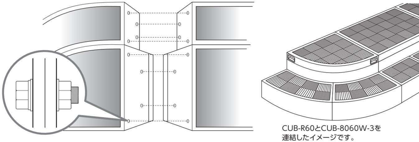
施工に際し、ハウスステップ設置部下の地面の状態を確認してください。本体の転倒防止および蓋開閉時の本体の浮き上がり防止のため、本体は地面と固定してください。
