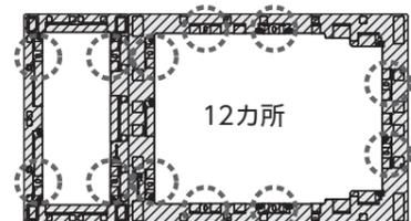
アジャスターの固定時ペグ・コンクリートボンド位置(斜線はモルタルを使用時のモルタル範囲)
