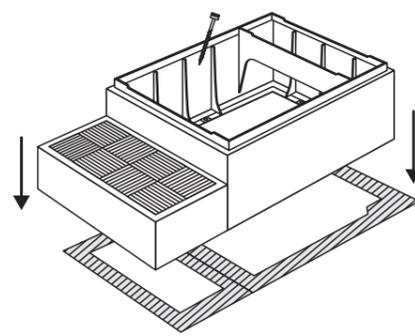
斜線部の範囲内にモルタルを敷き設置してください。モルタルがはみ出た場合は拭き取ります。収納庫をつける時は、内側リブより内側にはみ出したモルタルも拭き取り、モルタルが固まる前にペグを打ち込んでください。※ペグは斜め方向に打ち込むと、より確実に固定できます。
