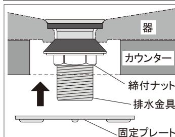
固定プレートの凸部の無い面をカウンター側に向かって、排水金具に通します。
