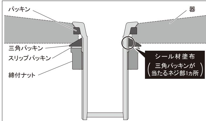
**!** 必ず実行 ●必ず指定位置に、シリコーンコーティング等のシール材(防カビタイプ)を塗布してください。漏水により家財等を濡らす財産損害発生の恐れがあります。
