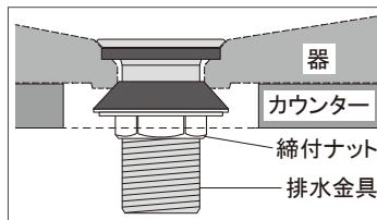
①締付ナットの飛出し寸法に合わせて、使用する角材の厚みを確認します。
