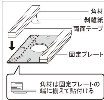
②角材を両面テープで固定プレートの両端に貼付けます。
