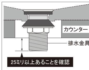
**!** 必ず実行 推奨する排水金具をご使用ください。推奨外の排水金具を使用した場合、器に同梱している固定プレート・固定ナットが使用できなくなります。
