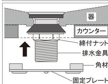
③固定プレートの角材を貼付けている面をカウンター側に向かって、排水金具に通します。
