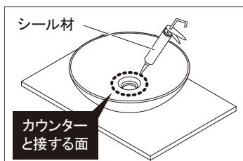
②器の底面(カウンターと接する面)にシール材を塗布し、カウンターに設置します。
