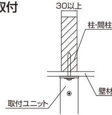
●幅30mm以上の柱・間柱へ取付けてください。
