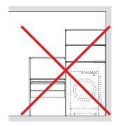
高さ1362mmプラン用の側板と、 高さ1990mmプラン用の側板・ 仕切板を組み合わせることはでき ません。
