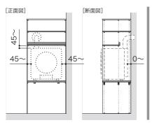
[その他の衣類乾燥機を設置する場合] 離隔距離は各家電メーカーの設置条件 に準じて設置してください。
